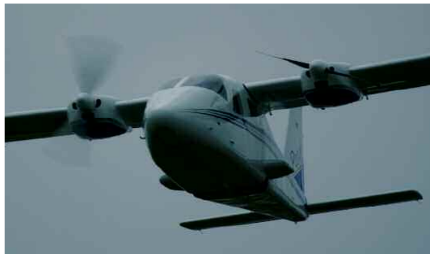
Démonstration du vol sur un moteur, l'hélice du Rotax gauche étant en drapeau.
