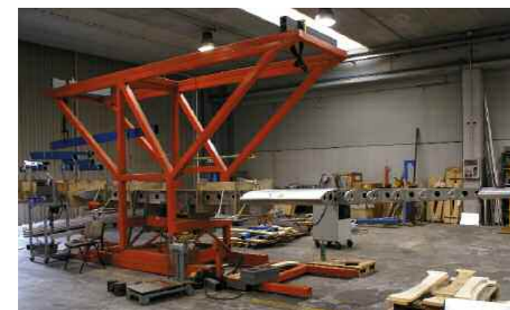
Banc d'essais statiques pour la voilure avec la cellule n°00 destinée au processus de certification CS-23.
